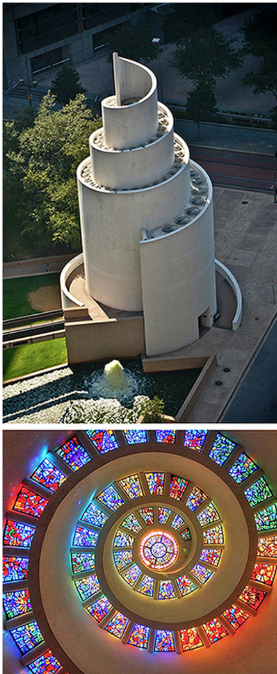
Fig. 3 Philip Johnson, Thanks-Giving Square Park, Chapel and Museum, Dallas, Texas (USA), 1976. In alto, una vista dell'esterno della struttura; superficie cilindrica a direttrice elicoidale conica. In basso, una vista dall'interno; lucernaio ad andamento elicoidale conico.
